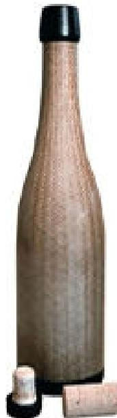
Pesant 170 g pour 75 cl, cette bouteille est fabriquée à partir d'un tissage cylindrique et préformé de fibres de lin appelé «mat». Elle dispose d'un film protecteur intérieur alimentaire permettant d'empêcher toutes transmissions d'odeurs et/ou de nanoparticules venus du lin et de la résine dans le contenu. Ce film, qui représente 9 % de la masse totale, ne sera 100 % biosourcé que dans 6 à 18 mois.
